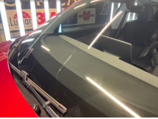
Camlar, Ön cam > Çatlak
