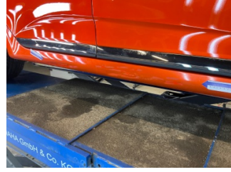
Marşbiyel, sağ, Marşbiyel, sağ > Hasarlı
