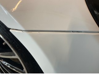
Tampon, ön, Ön tampon > Sabitlemesi Hatalı
