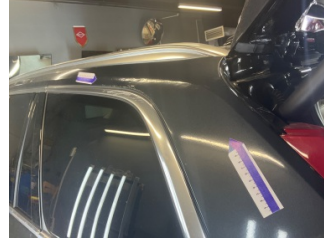
Kaporta, Sol Üst Frangart > Standart Dışı Onarım
