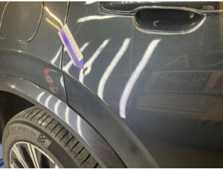
Kapı, sağ arka, Kapı, sağ arka > Ezik
