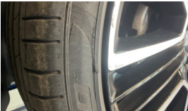
Lastik, sol ön > Deforme Olmuş
