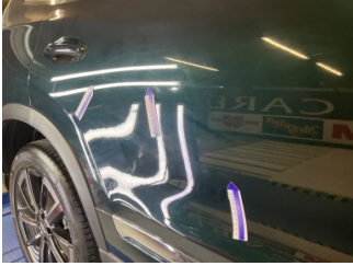
Kapı, sağ arka, Kapı, sağ arka > Çizik
