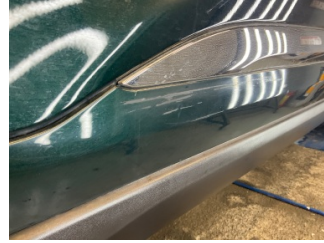
Kapı, sol ön, Kapı bandı > Çizik
