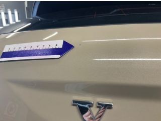
Bagaj kapağı/kapısı, Bagaj kapısı > Noktasal Ezik
