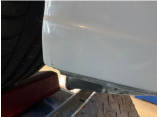
Tampon, ön, Ön tampon > Çatlak
