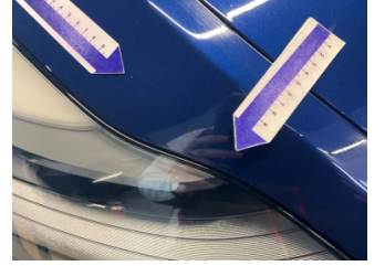
Çamurluk, sağ, Çamurluk, sağ > Taş Izi
