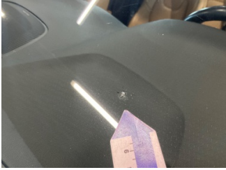
Camlar, Ön cam > Çatlak
