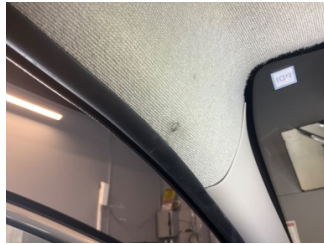
Döşemeler/Kapaklar, Tavan döşemesi > Standart Dışı Onarım
