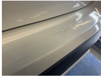
Tampon, arka, Arka tampon > Çatlak
