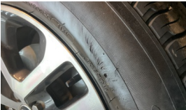
Lastik, sağ ön > Deforme Olmuş
