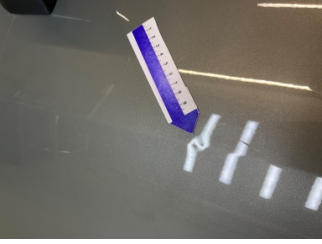
Kapı, sol  n, Kapı, sol  n > Noktasal Ezik
