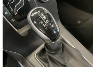
Şanzıman, Vites topuzu > Çatlak
