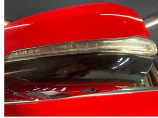
Dikiz aynası, sol, Sinyal lambası > Deforme Olmuş
