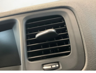
Kalorifer/Klima, Havalandırma ızgarası > Kırılmış
