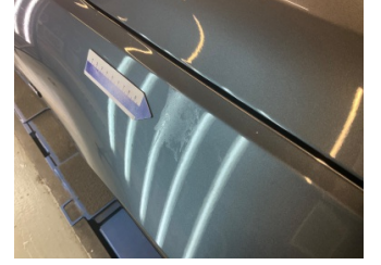
Çamurluk, sağ, Çamurluk, sağ > Yakıcı Madde ile Zarar Görmüş
