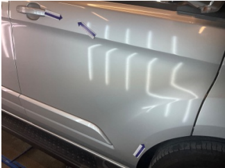
Kapı, sağ ön, Kapı, sağ ön > Çizik
