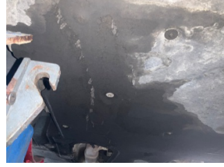
Motor, Alt muhafaza > Deforme Olmuş
