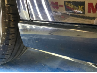
Marşbiyel, sağ, Marşbiyel plastığı, sağ > Çizik
