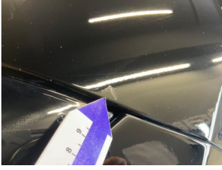
Çamurluk, sol, Çamurluk, sol > Rötüş
