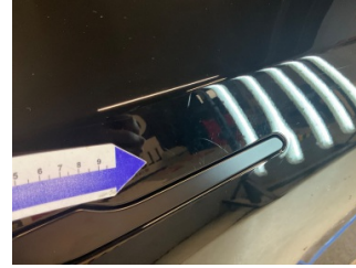
Kapı, sağ arka, Kapı, sağ arka > Çizik
