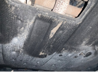
Motor, Alt muhafaza > Deforme Olmuş
