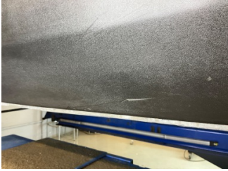
Kapı, sol ön, Kapı bandı > Çizik
