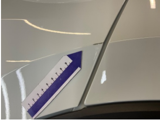
Kapı, sol arka, Kapı, sol arka > Çizik
