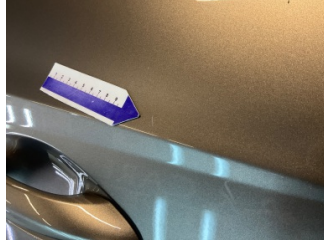
Kapı, sağ ön, Kapı, sağ ön > Çizik
