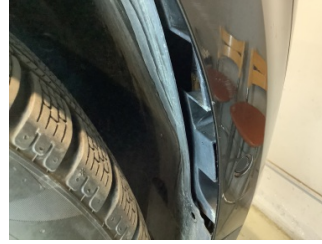
Çamurluk, sağ, Davlumbaz > Sabitlemesi Hatalı
