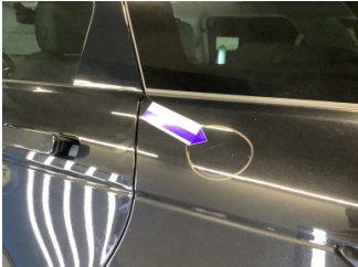
Çamurluk, sol arka, Çamurluk, sol arka > Çizik
