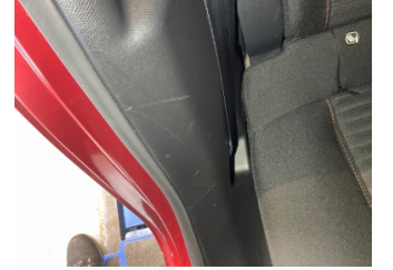
Döşemeler/Kapaklar, C-direk iç kaplaması, sağ > Çizik
