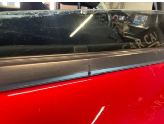
Kapı, sağ arka, Cam sıyrıcı fitili, dış > Deforme Olmuş
