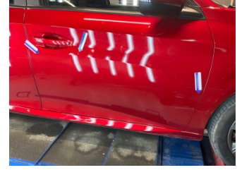
Kapı, sağ ön, Kapı, sağ ön > Çizik
