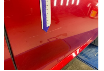
Kapı, sol arka, Kapı, sol arka > Çizik
