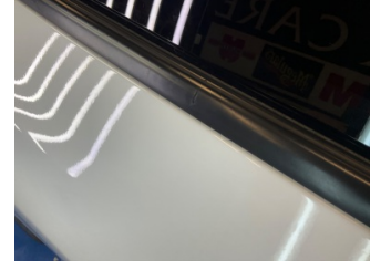
Kapı, sağ arka, Cam sıyrıcı fitili, dış > Deforme Olmuş
