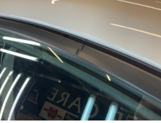
Camlar, Kapı camı fitili, sağ ön > Deforme Olmuş
