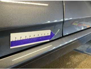
Kapı, sol ön, Kapı, sol ön > Ezik
