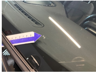
Camlar, Ön cam > Çatlak
