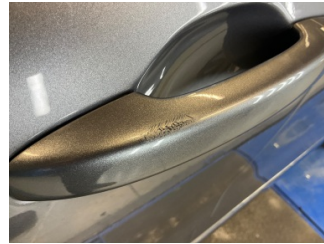
Kapı, sol ön, Kapı kolu, dış > Deforme Olmuş
