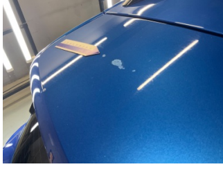
Bagaj kapağı/kapısı, Arka spoyler > Yakıcı Madde İle Zarar Görmüş
