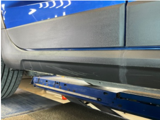
Marşbiyel, sağ, Marşbiyel plastığı, sağ > Çizik
