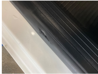
Kapı, sol ön, Kapı fitili > Yıpranmış
