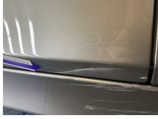
Kapı, sağ arka, Kapı, sağ arka > Ezik
