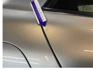
Kapı, sağı arka, Kapı, sağı arka > Yakıcı Madde Ile Zarar G rm ş
