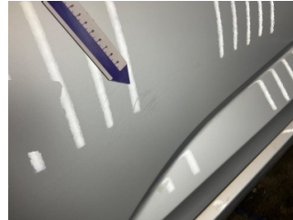
Kapı, sol ön, Kapı, sol ön > Çizik
