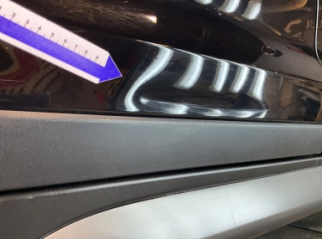
Kapı, sağ arka, Kapı, sağ arka > Ezik
