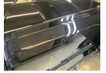
Kapı, sol ön, Kapı, sol ön > Ezik
