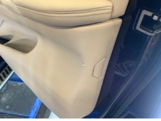
Döşemeler/Kapaklar, Döşemeler/Kapaklar > Deforme Olmuş
