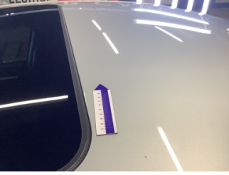
Tavan, Tavan > Dolu Hasarı
