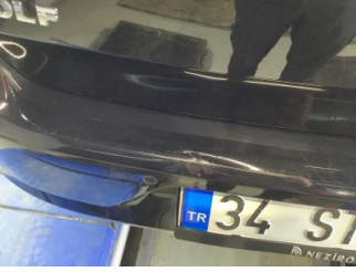
Tampon, arka, Arka tampon > Standart Dışı Onarım
