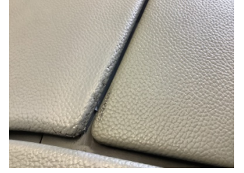
Döşemeler/Kapaklar, Döşemeler/Kapaklar > Deforme Olmuş
