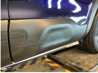
Kapı, sol arka, Kapı bandı > Çizik
