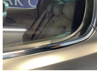
Camlar, Kapı camı fitili, sol arka > Deforme Olmuş
