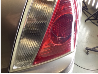
Arka lambalar, Arka lamba camı, sağ > Çatlak
