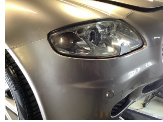
Tampon, ön, Ön tampon > Sabitlemesi Hatalı
