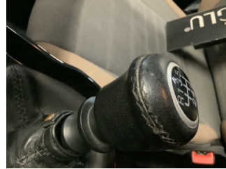
Şanzıman, Vites topuzu > Deforme Olmuş
