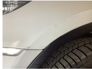
Çamurluk, sol, Çamurluk, sol > Rötüş
