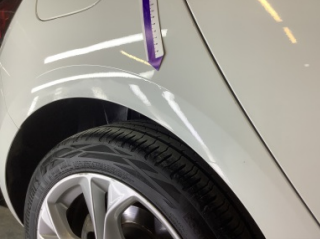
Çamurluk, sağ arka, Çamurluk, sağ arka > Ezik
