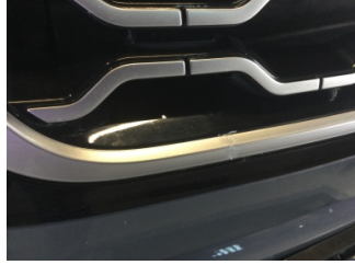
İlave parçalar, ön, Ön panjur > Çatlak
