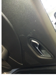
Döřemeler/Kapaklar, Kapı döřemesi, sol arka > izik
