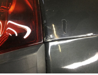
Çamurluk, sağ arka, Çamurluk, sağ arka > Ezik
